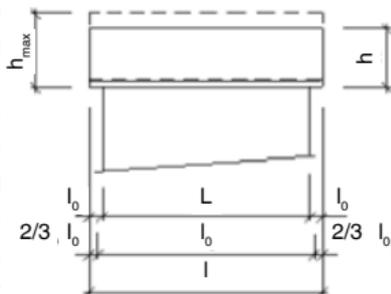
мычками – зоны распора – можно использовать обожженные, силикатные, бетонные кирпичи и блоки, поперечная прочность которых (т.е. после укладки над перемычками вдоль горизонтальных осей перемычек) составляет в среднем хотя бы 2,5 МПа, а по отдельности – хотя бы 2,0 МПа.
