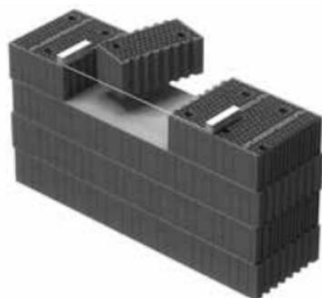
Укладывают в свежий раствор кирпич за кирпичом впритык вдоль шнура (перевязка в паз и гребень обеспечивает правильную укладку кирпичей). Положение кирпичей проверяйте по уровню и рейке и поправляйте с помощью резинового молотка. Керамические блоки не должны выступать за фундамент или перекрытие бо-
