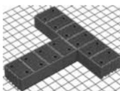
Перевязка с внутренней стеной толщиной 250 мм
