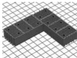
Перевязка с внутренней стеной толщиной 380 мм
