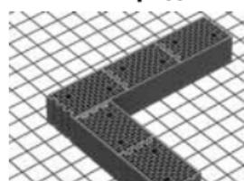
Перевязка с внутренней стеной толщиной 250 мм
