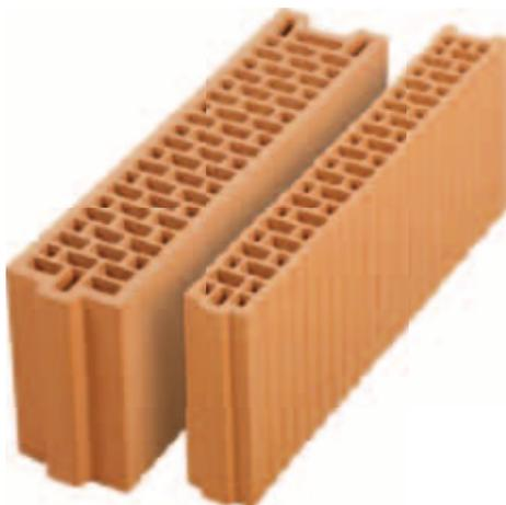
Крупноформатные керамические камни Porotherm 8 и Porotherm 12 предназначены для кладки внутренних ненесущих межкомнатных стен в один ряд толщиной 80 мм и 120 мм соответственно. Минимальная толщина блоков Porotherm 8 и Porotherm 12 позволяет значительно увеличить полезную площадь помещения, сократить трудозатраты и расход раствора. Соединение вертикальных швов в паз и гребень также существенно ускоряет монтаж и экономит раствор.
