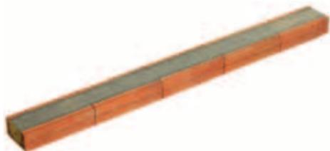
Керамобетонные перемычки Porotherm 120/65 применяются в оконных и дверных проёмах. Практически не уступая обычным железобетонным перемычкам в прочности благодаря железобетонной сердцевине и применению бетона высокой марки, керамобетонные перемычки Porotherm 120/65 выгодно отличаются от них:
