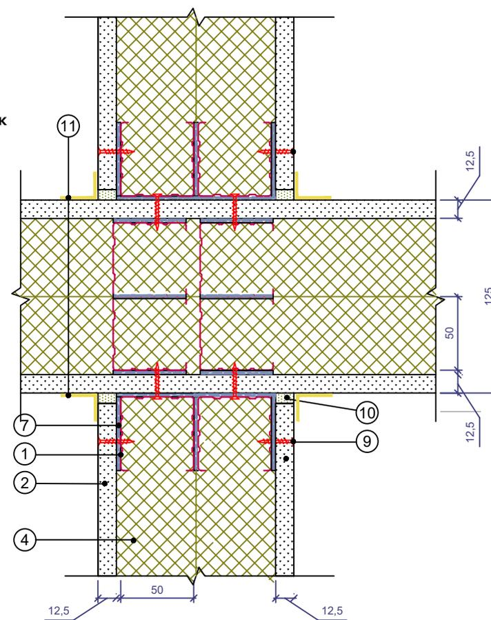
**Перегородки с металлическим каркасом.
