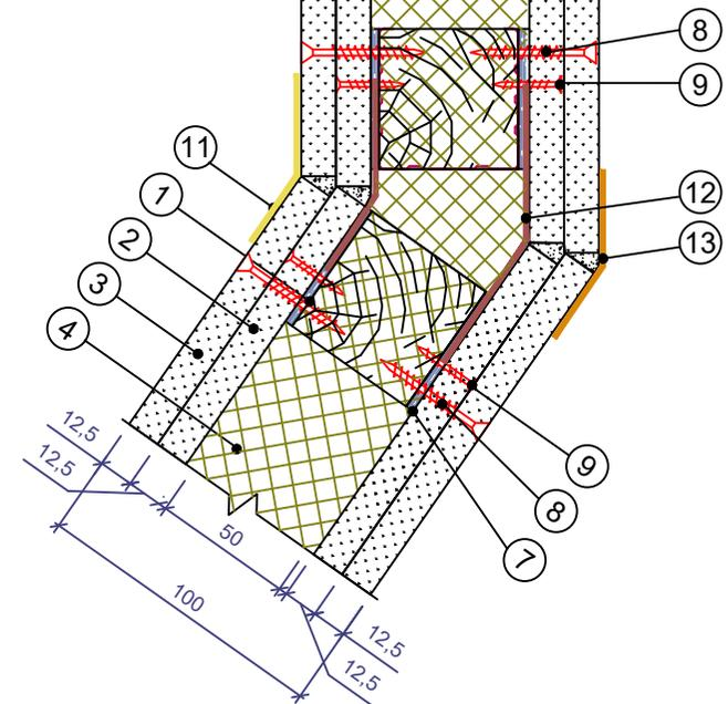
Звукоизоляционная эффективность перегородок с деревянным каркасом и с двумя слоями обшивки с каждой стороны находится в диапазоне 48-53 дБ (Rw) в зависимости от её состава. Подробное описание в Таблице №6 (стр.21)
