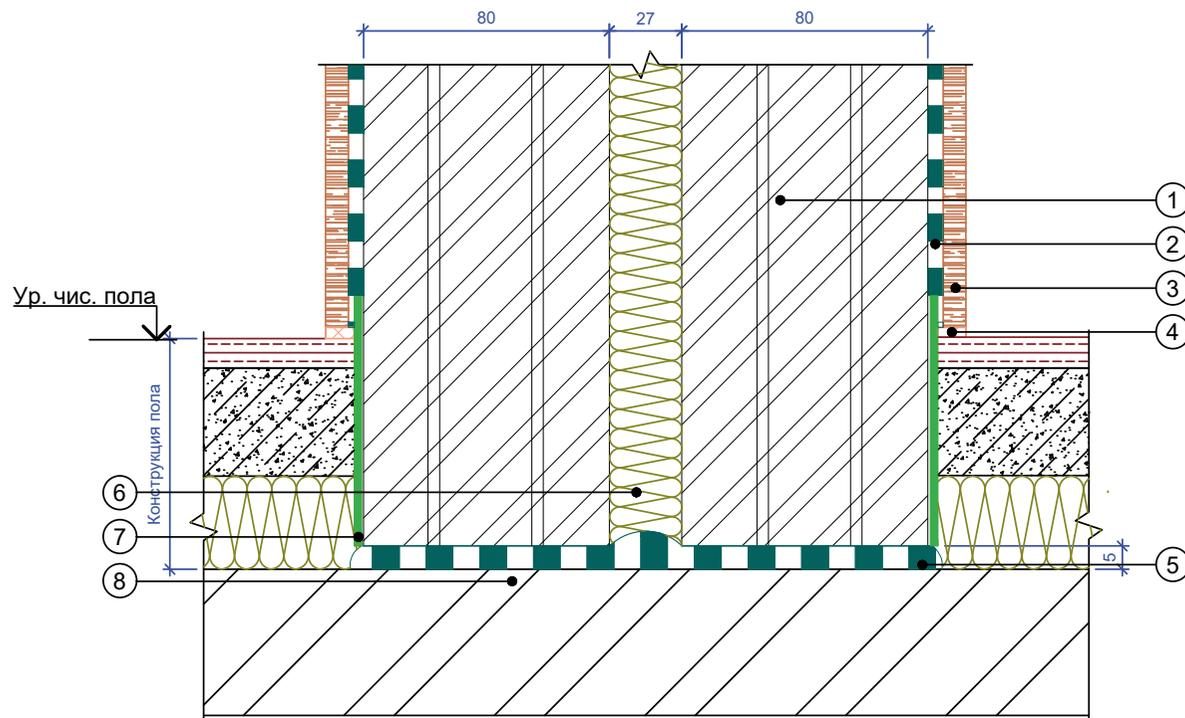
**Акустическая звукоизоляционная кладка
