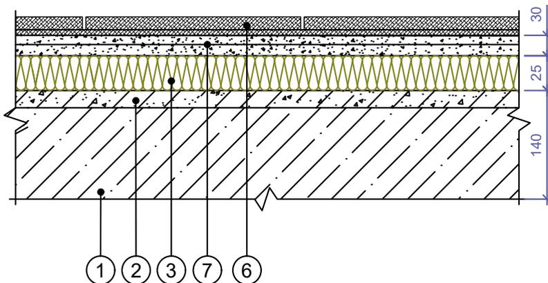
Звукоизоляционная эффективность полов находится в диапазоне 55-58 дБ (Rw) и 48-37 дБ (Lnw) в зависимости от их состава и типа перекрытий. Подробное описание в Таблице №15 (стр.37-38)
