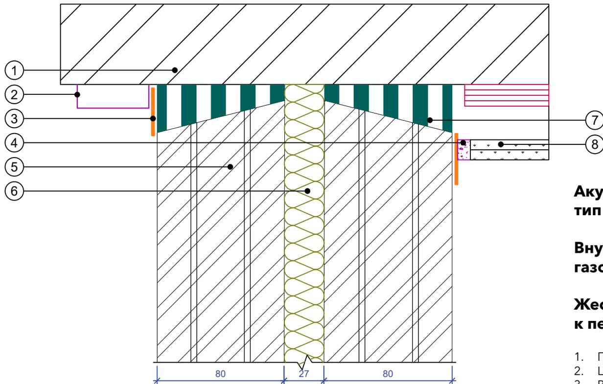
**Акустическая звукоизоляционная кладка
