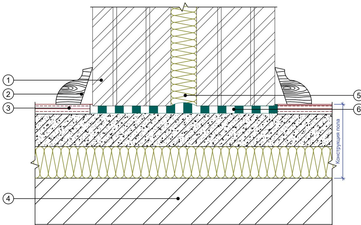
**Акустическая звукоизоляционная кладка
