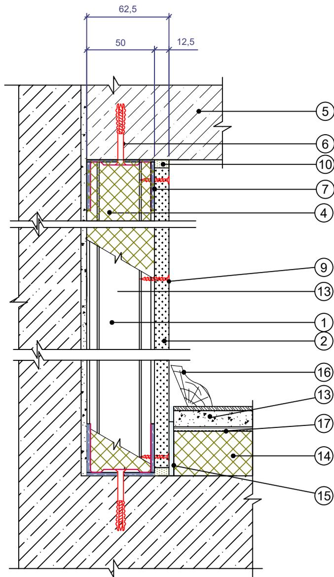
**Облицовки с металлическим каркасом.
