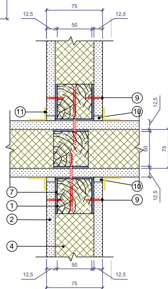
Звукоизоляционная эффективность перегородок с деревянным каркасом и с одним слоем обшивки с каждой стороны находится в диапазоне 44-48 дБ (Rw) в зависимости от её состава. Подробное описание в Таблице №6 (стр.21).
