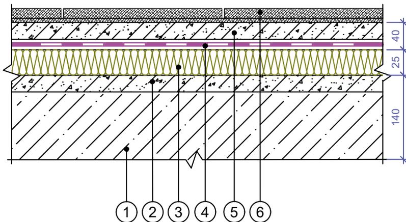
1. Бетонное (железобетонное) перекрытие
