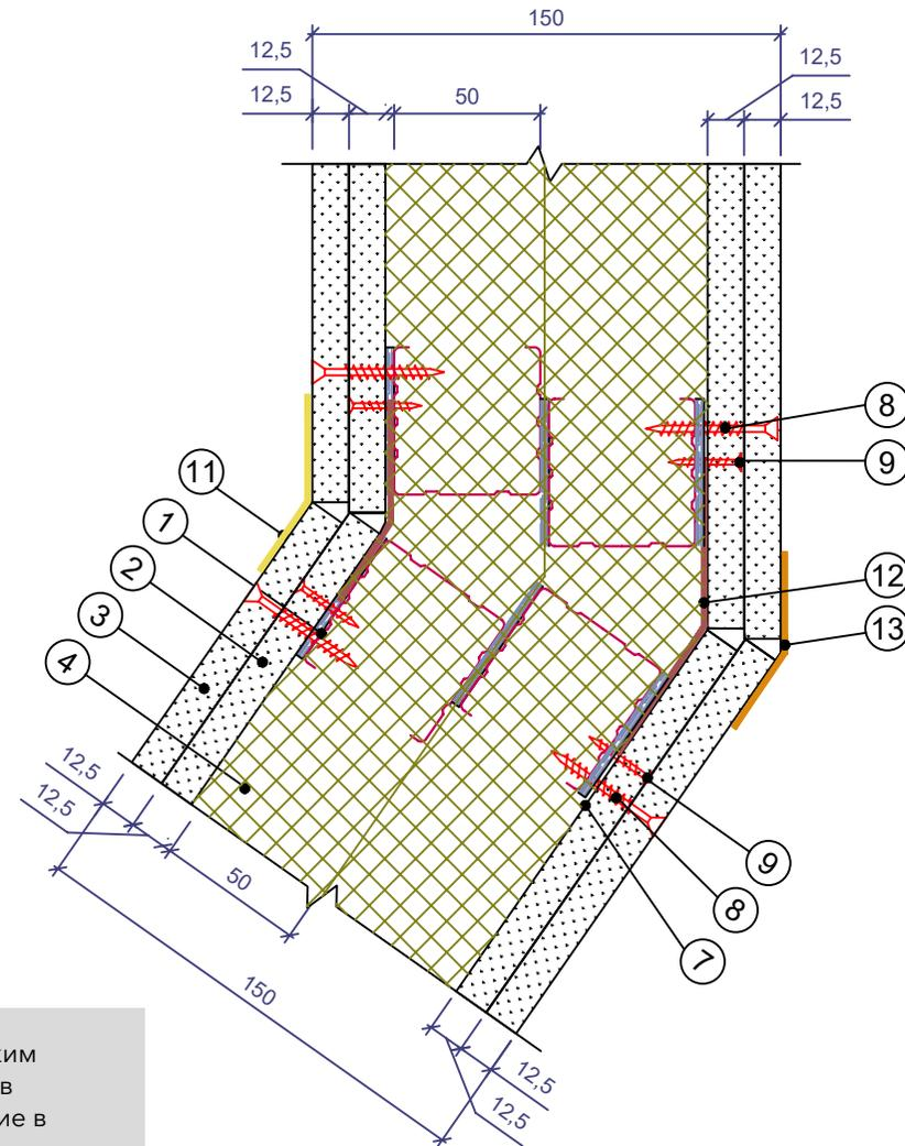
Звукоизоляционная эффективность перегородок с двойным металлическим каркасом и с двумя/тремя слоями обшивки с каждой стороны находится в диапазоне 56-64 дБ (Rw) в зависимости от её состава. Подробное описание в Таблице №6 (стр.20).
