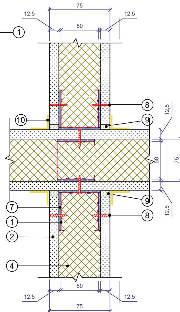
**Перегородки с металлическим каркасом.
