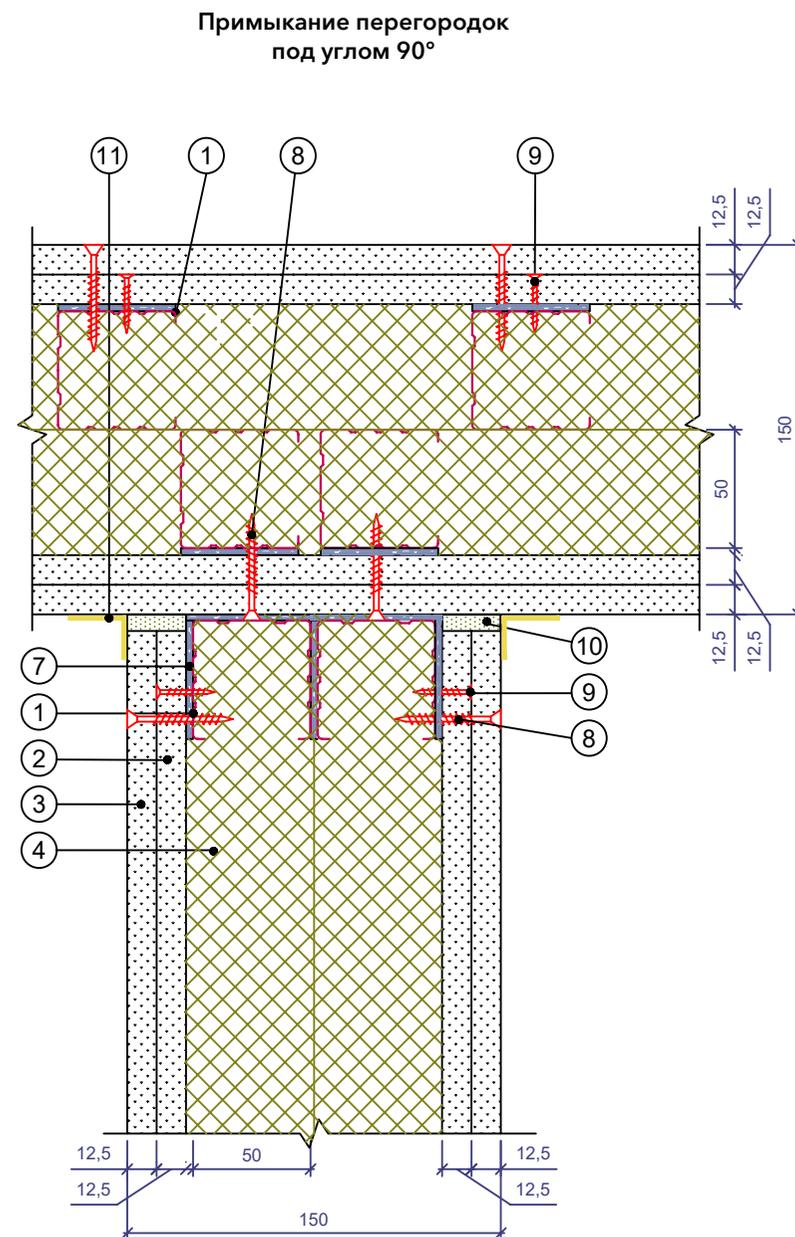
**Перегородки с металлическим каркасом.
