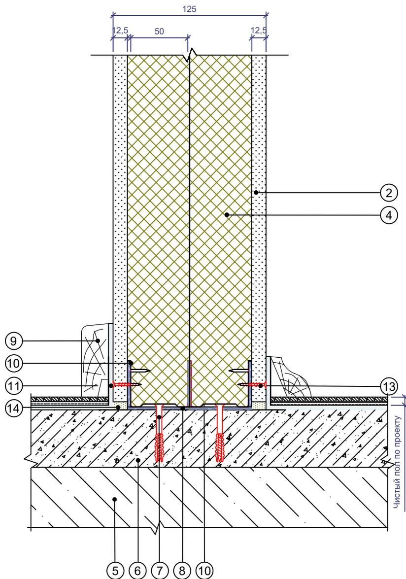
**Перегородки с металлическим каркасом.
