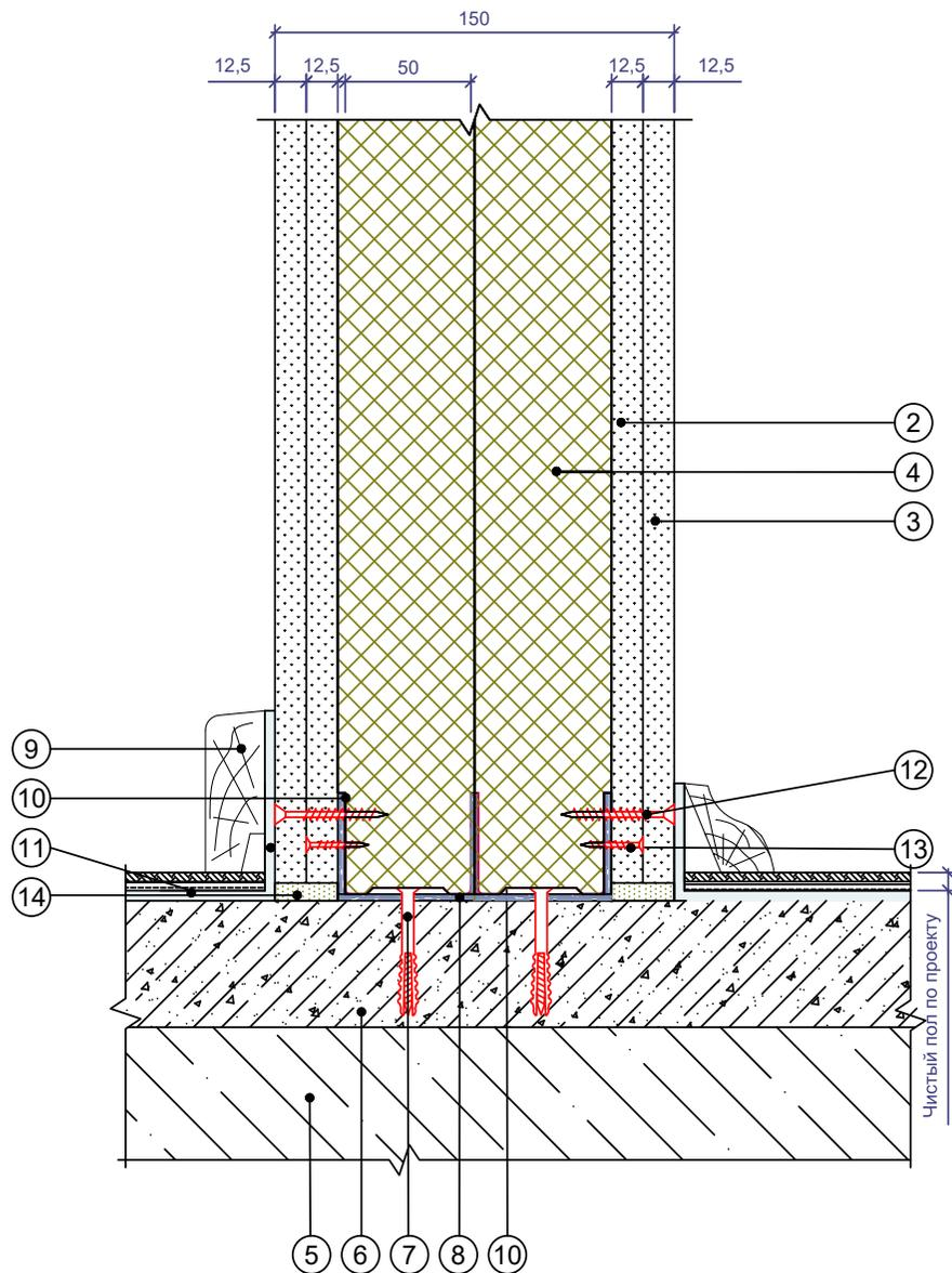
**Перегородки с металлическим каркасом.
