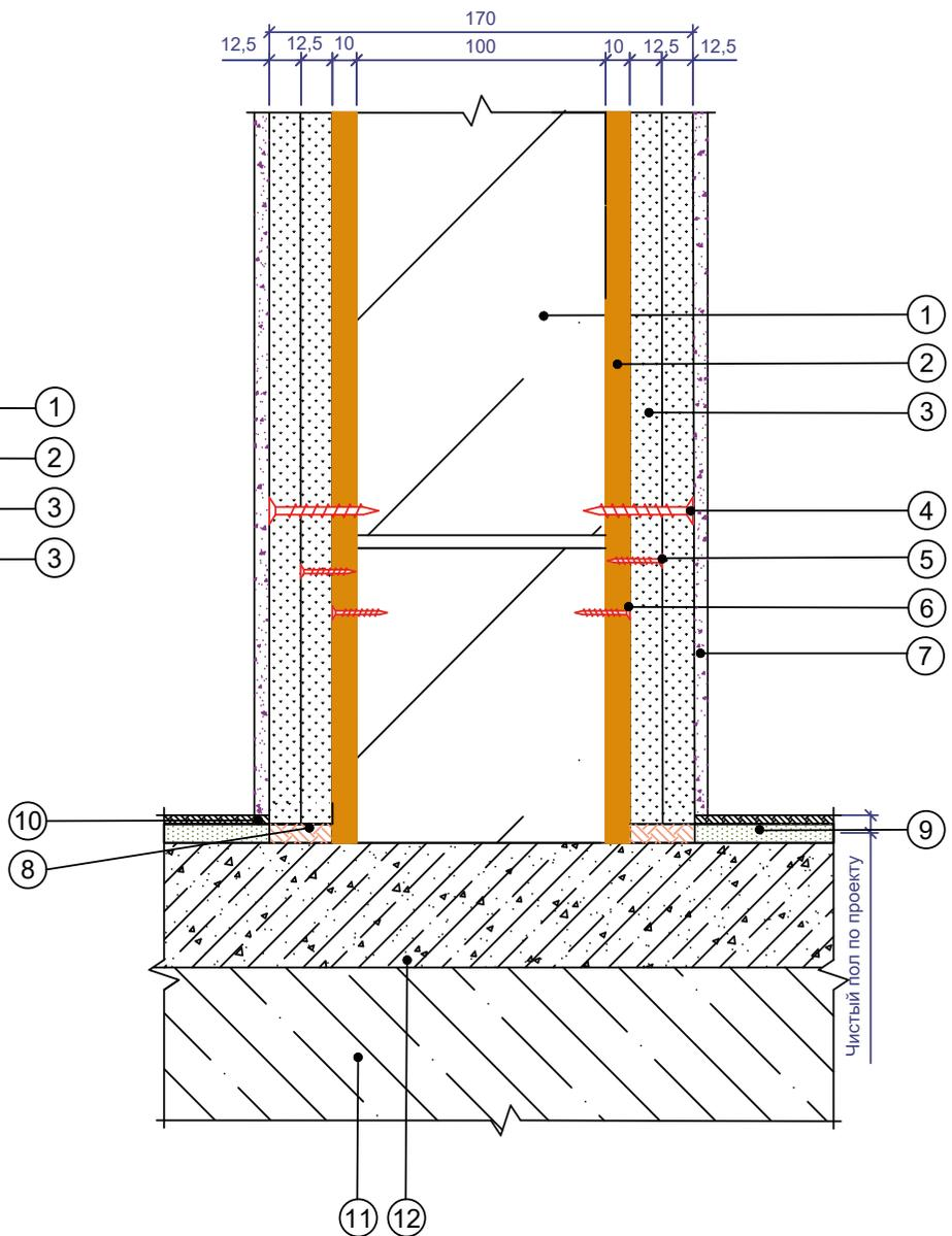
**Бескаркасная звукоизолирующая облицовка тип ОС-БК-002.**
