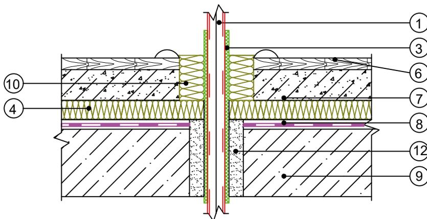
**Звукоизоляционный пол тип СП-ЦП-25
