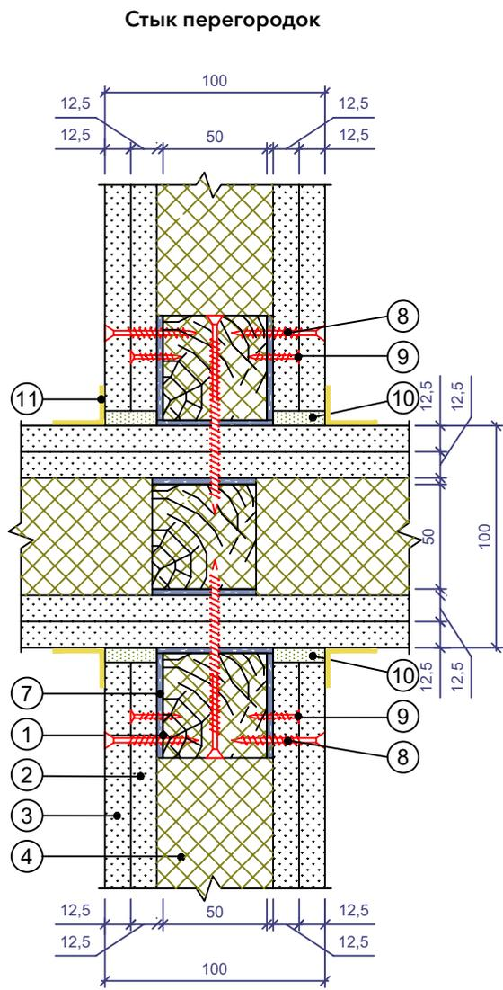
**Перегородки с деревянным каркасом.
