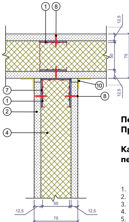
**Перегородки с металлическим каркасом.
