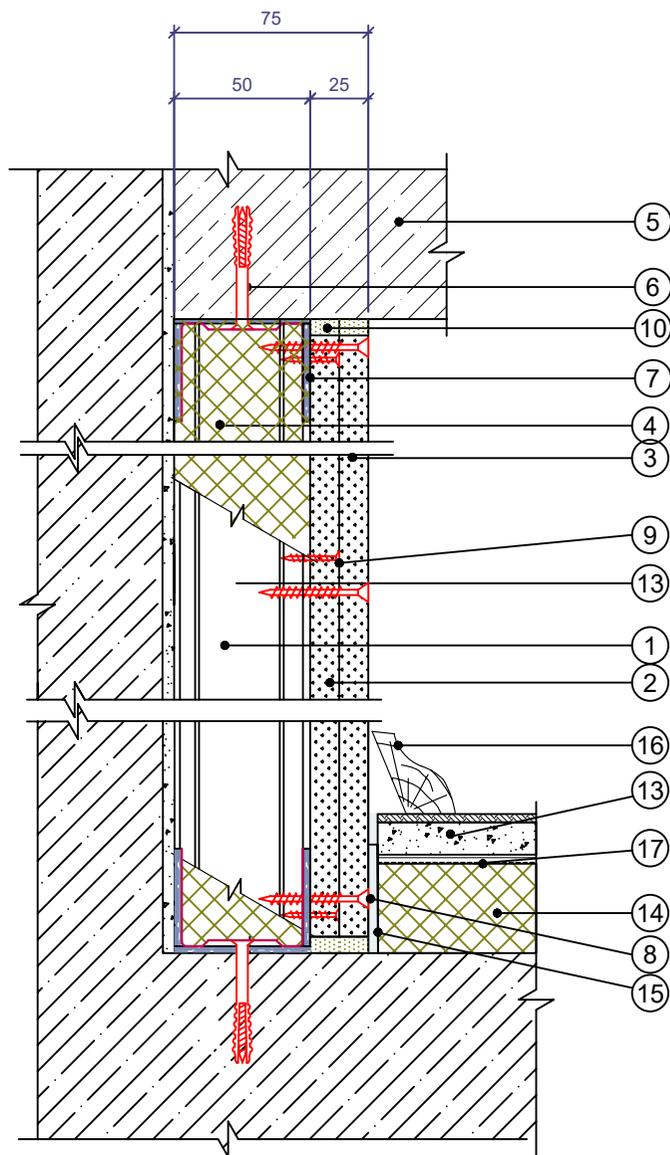
Облицовка также может быть смонтирована поверх плавающего пола.
