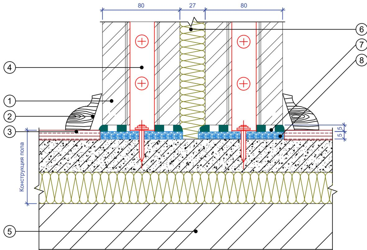
**Акустическая звукоизоляционная кладка
