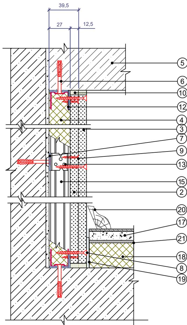
**Облицовки с металлическим каркасом.
