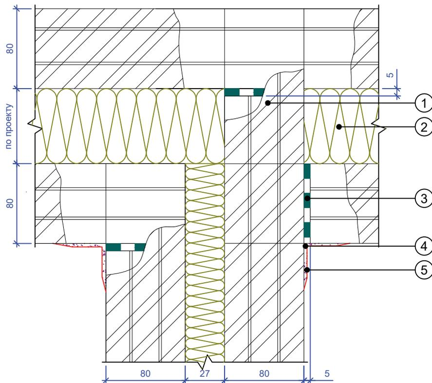
**Акустическая звукоизоляционная кладка
