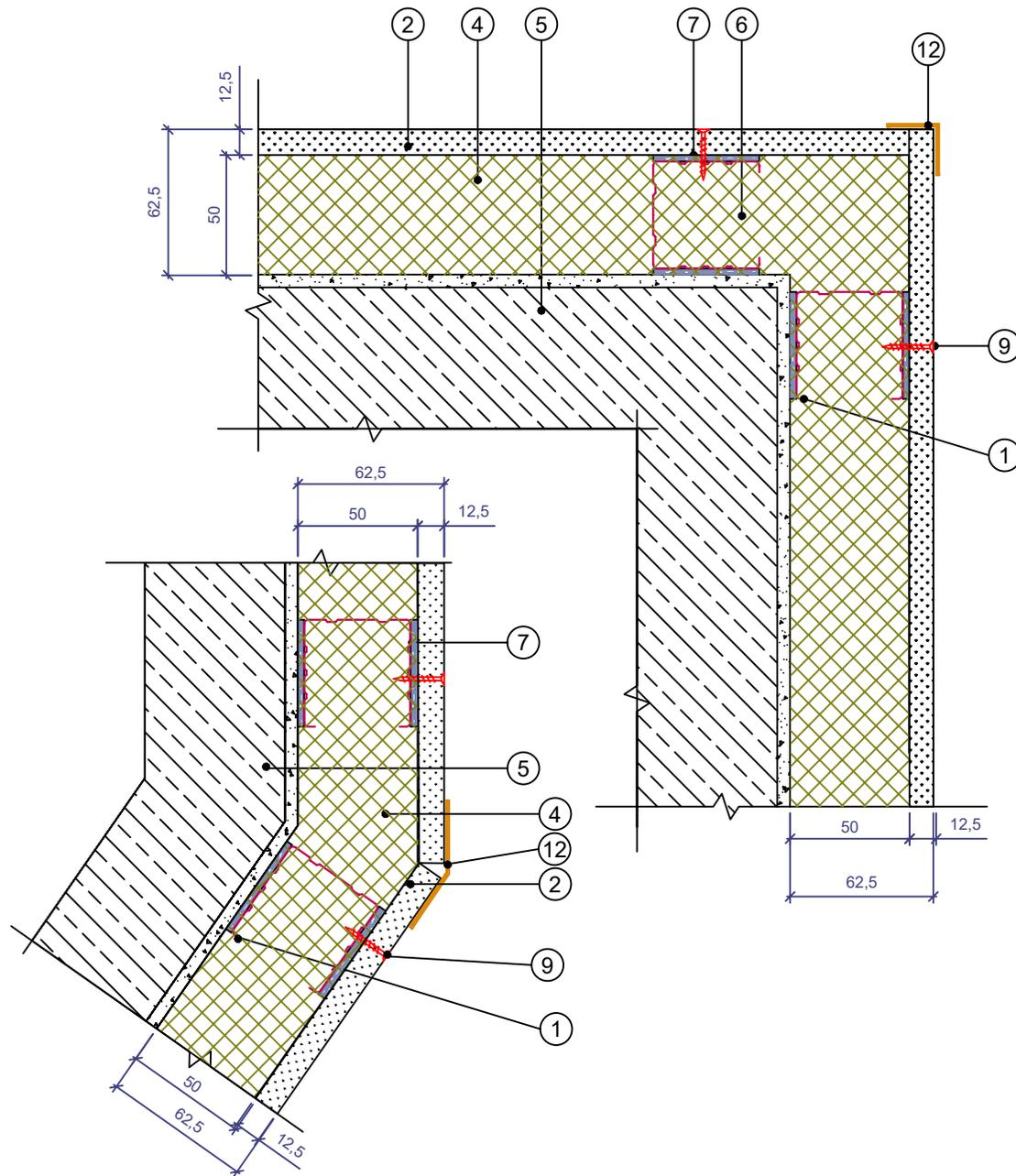
**Облицовки с металлическим каркасом.
