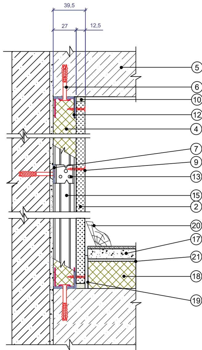
**Облицовки с металлическим каркасом.
