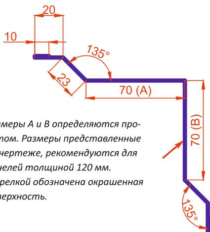
Размеры А и В определяются проектом. Размеры представленные на чертеже, рекомендуются для панелей толщиной 120 мм.
