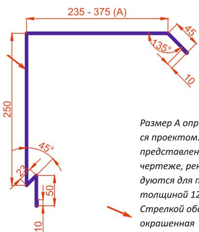
Размер А определяется проектом. Размеры представленные на чертеже, рекомендуются для панелей толщиной 120 мм. Стрелкой обозначена окрашенная поверхность.
