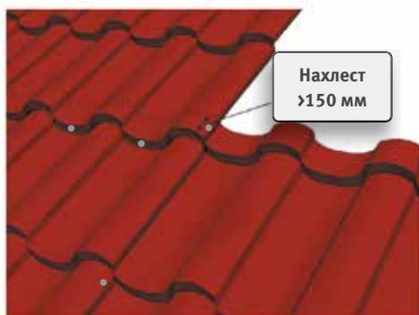
Листы металлочерепицы соединяют вдоль ската с нахлестом минимум 150 мм. Фиксацию поперечного нахлеста возможно выполнять в торец поперечной волны или в низ каждой продольной волны над поперечной волной, без крепления к обрешетке. При этом используются саморезы 4,8 x 20 по металлу.
