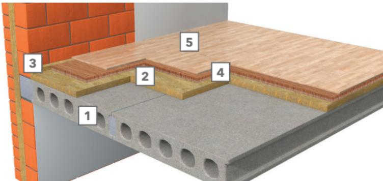
1. Железобетонная плита (основание).
