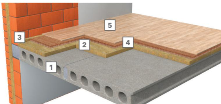
1. Железобетонная плита (основание).
