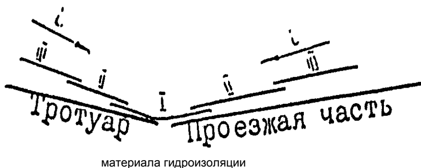
Рисунок 10 Порядок укладки материала гидроизоляции
